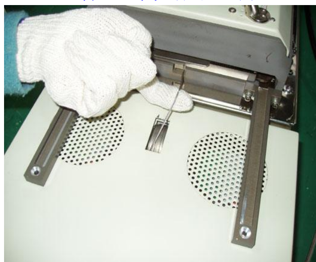
调整钢丝进入转轮沟槽
